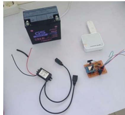
Gambar 4.3 Node Sensor dan Modul Komunikasi dihidupkan menggunakan aki melalui modul Buck Converter 5 Volt
