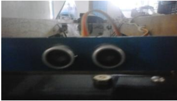
Gambar 8. Letak dan Posisi Pemasangan Sensor PING
