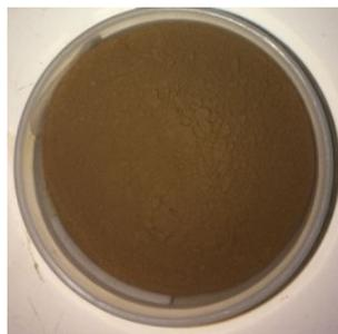
Gambar 4. Pasir Besi Berukuran Nanopartikel
