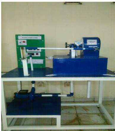
Gambar 2 Alat Turbin Air Pelton Di Laboratorium
