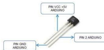
**Gambar 8.** Konfigurasi Sensor Efek Hall
