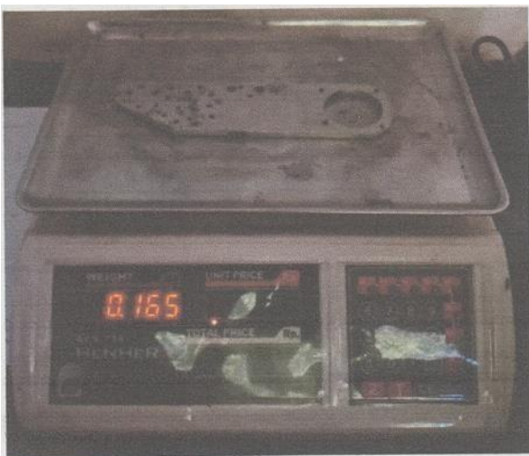
Gambar 20. hasil pengukuran berat komponen knuckle plate setelah di porong sesuai dengan dimensi
