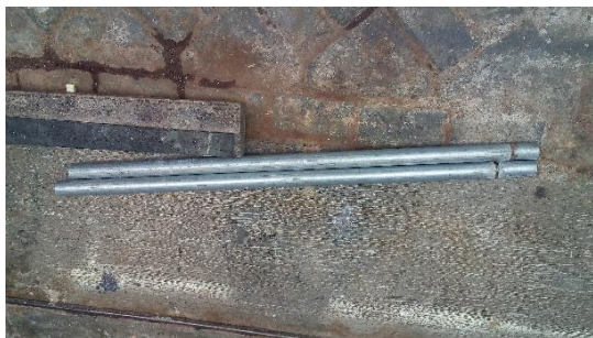
Gambar 9. Besi Tiang Penyangga Yang akan digabung dengan tiang penyangga yang menghubungkan dengan turbin.
