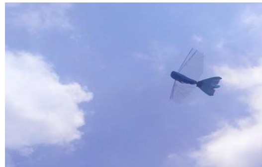
Gambar 16 Pengujian Terbang di Lapangan Lodaya
