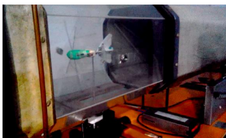
Gambar 18 Robot Papatong diuji dalam wind tunnel
