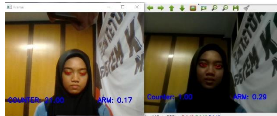
Gambar 18. Contoh Hasil Perbandingan Kedipan Mata di Raspberry Pi (Kanan) Dengan Personal Computer (Kiri)
