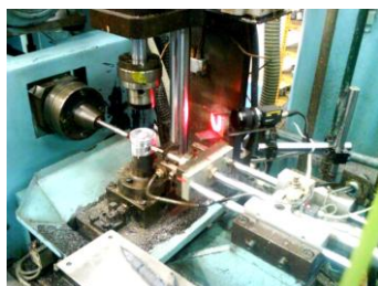
Gambar 6. Mesin PHF dengan penambahan vision sensor
