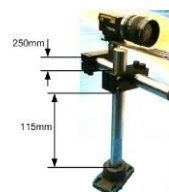
Gambar 5. Jarak antar strut clamp pada konstruksi mekanik yang sudah disesuaikan dengan letak piston pada mesin PHF
