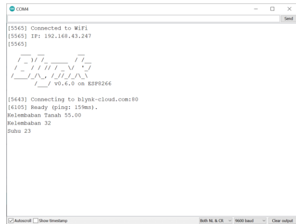
Gambar 5 Pengujian koneksi esp32 ke internet melalui serial monitor
