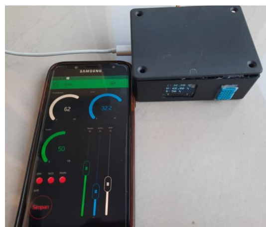
Gambar 8 tampilan kondisi suhu dan kelembaban melalui aplikasi blynk dan layar LCD
