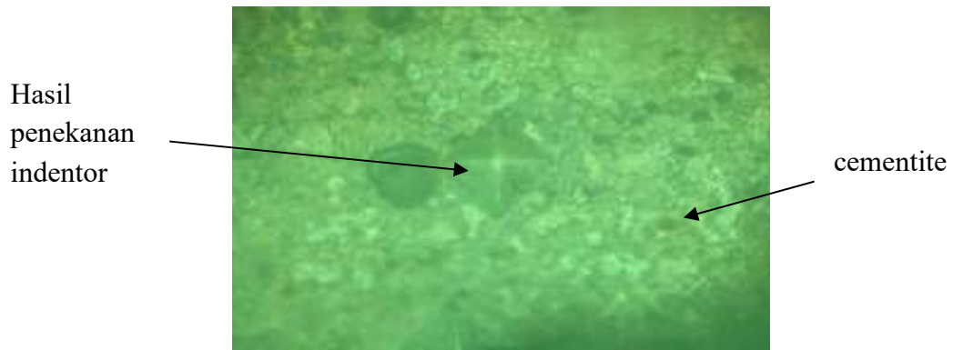
Gambar 22. Struktur mikro stainless steel VHN 148,15. Pembesaran lensa 400 x
