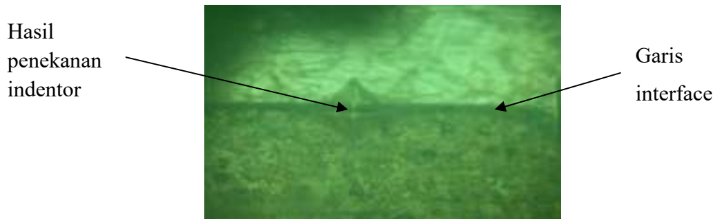
Gambar 26. Daerah interface baja karbon rendah dan stainless steel VHN 103,45.
