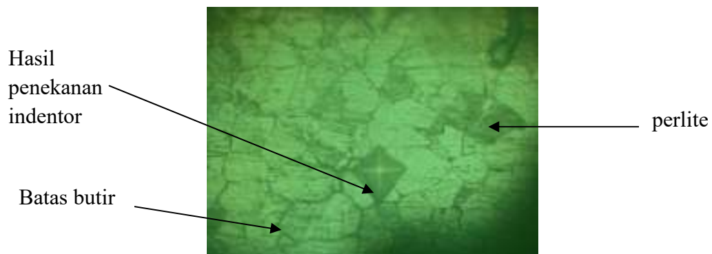
Gambar 25. Struktur mikro baja karbon rendah VHN 202,19.
