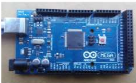
Gambar 1. Mikrokontroler Arduino Mega 2560
