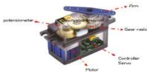
Gambar 2. Konstruksi motor servo
