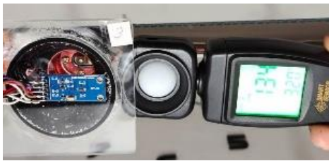
Gambar 9. Pengujian hasil pembacaan Kelima sensor Lux BH1750 terhadap Lux Meter (Pabrikan)
