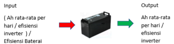
Gambar 2. kapasitas input baterai dengan memperhitungkan efisiensi baterai dan inverter
