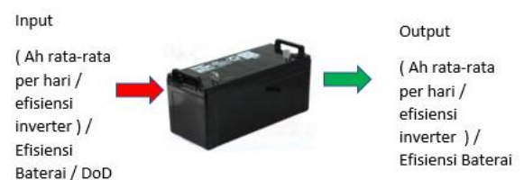
Gambar 5. Kapasitas input baterai dengan memperhitungkan DoD, efisiensi baterai dan efisiensi inverter
