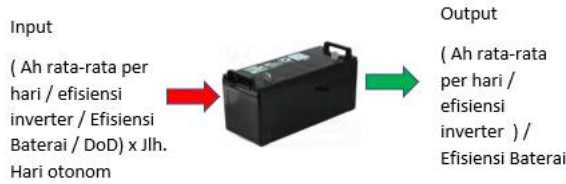
Gambar 6. Kapasitas input baterai dengan memperhitungkan hari otonom, DoD, efisiensi baterai dan efisiensi inverter
