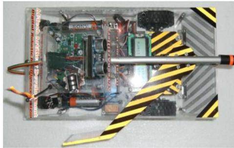
Gambar 8. Robot Tampak Atas dengan Penghempas
