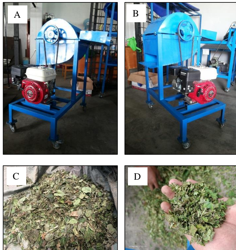
Gambar 10. Mesin Pencacah Tumbuhan Nilam (A, B), Hasil Cacahan (C, D)
