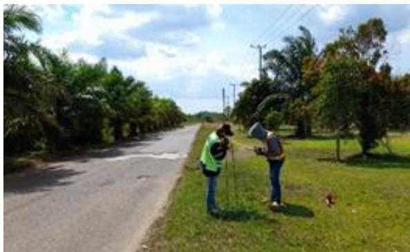
Gambar 2. Pengambilan Tanah dengan DCP
