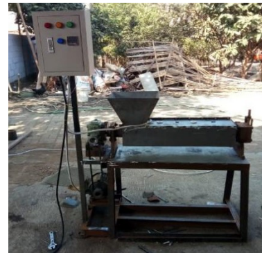
Gambar 5. September 2019 – Tahap I Uji Coba Alat Pelebur Sampah Plastik
