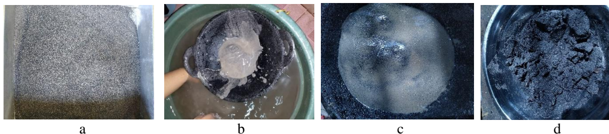
Gambar 1. a) pasir puya sebelum didulang, b) pendulangan pasir puya, c) pasir putih mulai terpisah dari pasir hitam, d) pasir hitam.
