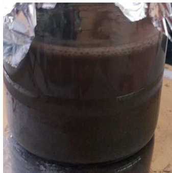
Gambar 9. Hasil uji kelarutan logam tailing timah dalam DES
