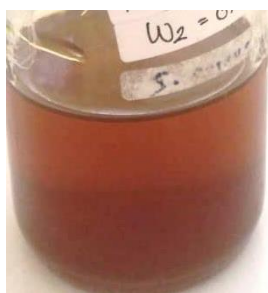
Gambar 10. Hasil penyaringan logam tailing timah dan DES
