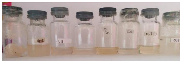
Gambar 2. Hasil pencampuran biner ChCl : PTSA pada temperatur kamar
