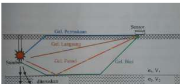
Gambar 1.3. Prinsip Kerja Penangkapan Gelombang
