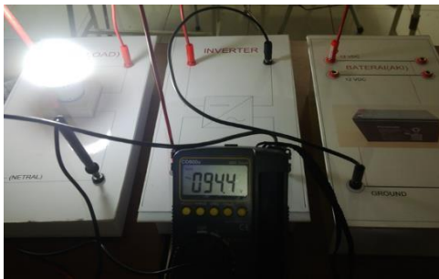
Gambar 8. Pengukuran Inverter Tanpa Beban
