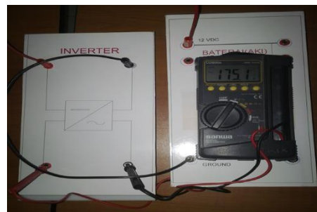
Gambar 8. Pengukuran Inverter Tanpa Beban
