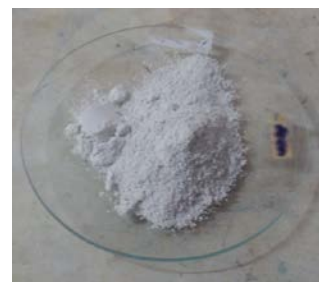
Gambar 3. Hidroksiapatit hasil sintesis variasi Ca:P = 1:0,065 1000 °C
