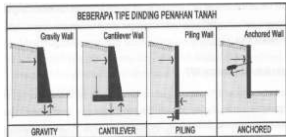
Gambar 5. Tipe Dinding Penahan Tanah Sumber: Hakim, Rustam. 2012
