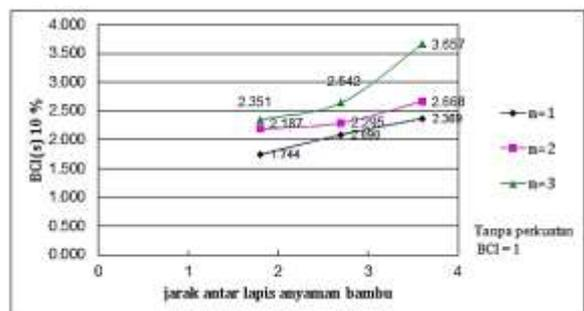
**Gambar 18.** Grafik nilai  $BCI_{(s)}$  10% untuk variasi jarak antar lapis anyaman bambu
