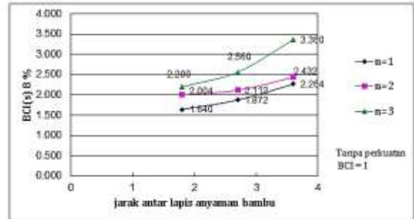
**Gambar 17.** Grafik nilai  $BCI_{(s)}$  8% untuk variasi jarak antar lapis anyaman bambu
