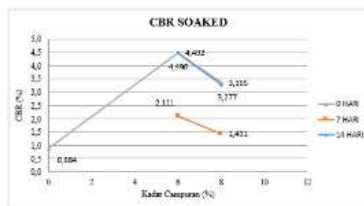
Gambar 6. Perbandingan Nilai CBR Terendam Pada Variasi Tanah Asli + 6% Serbuk Gypsum dan Tanah Asli + 8% Serbuk gypsum Dengan Curing Dan Tanpa Curing
