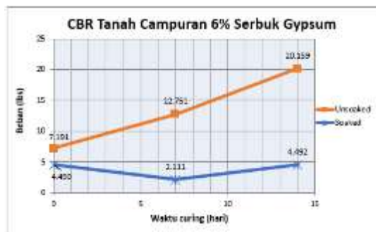
Gambar 7. Perbandingan Nilai CBR Unsoaked dan CBR Soaked pada Kondisi OMC dari Campuran Tanah Asli + 6% Serbuk Gypsum Dengan Curing dan Tanpa Curing
