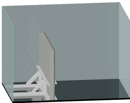
Gambar 3.4 Pemasangan filter ijuk pada dinding.
