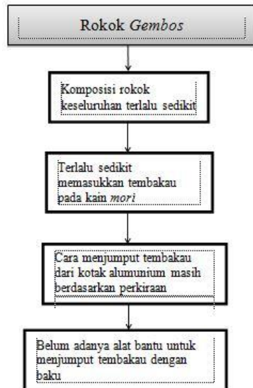
Gambar 16. RCA Defect Akibat Rokok Gembos
