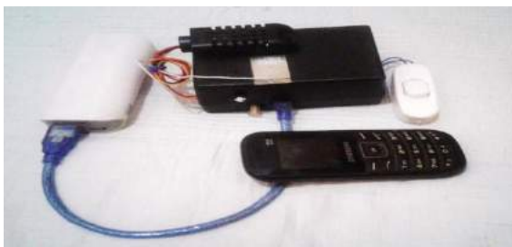
Gambar 8. Hasil Perancangan Monitoring Temperatur Ruangan
