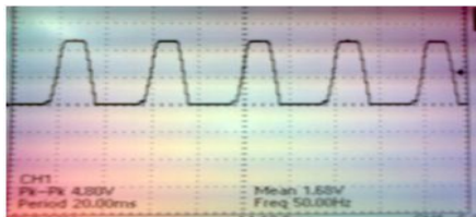
Gambar 10. Hasil keluaran pengujian rangkaian power line clock
