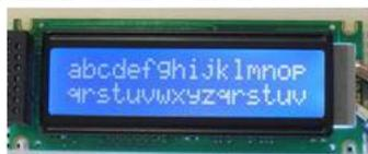
Gambar 6. Bentuk modul LCD 2x16 karakter
