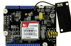
Gambar 3. Bentuk fisik GPRS Shield
