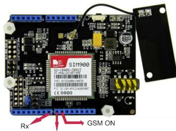
Gambar 11. Koneksi pin GPRS Shield dengan Arduino
