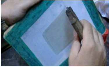
Gambar 4. Proses Pelapisan Resis ke Permukaan Screen
