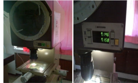
Gambar 12. Proses Pengukuran Menggunakan Profile Proyektor
