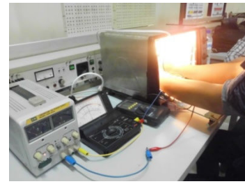
Gambar 21. Proses Pengukuran Tegangan Resistansi Konduktor dengan Perbedaan Suhu
