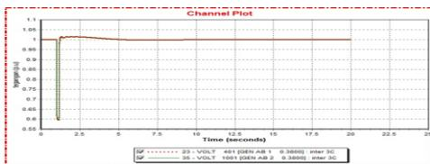
Gambar 17. Grafik tegangan =  $f(t)$  setelah interkoneksi pada bus GEN AB1 dan bus GEN AB2 saat diberikan gangguan pada bus load 3A
