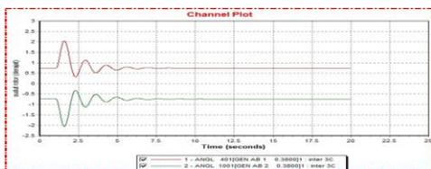
Gambar 18. Grafik sudut rotor =  $f(t)$  setelah interkoneksi pada bus GEN AB1 dan bus GEN AB2 saat diberikan gangguan pada bus load 3A
