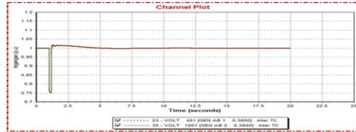
Gambar 19. Grafik tegangan =  $f(t)$  setelah interkoneksi pada bus GEN AB1 dan bus GEN AB2 saat diberikan gangguan pada bus load 3B
