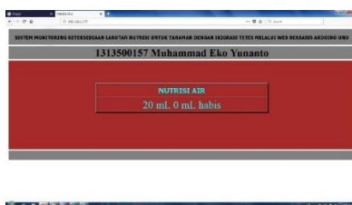
Gambar 4.2. Hasil Pengujian Ethernet Shield Pada Web Browser
