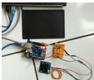
Gambar 5. Pengujian Kamera VC0706
