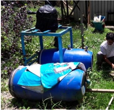
Gambar 3. Digester reaktor balon
