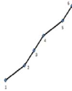
Gambar 6. spine linear dengan enam 6 titik kontrol
