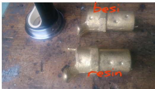
Gambar 5. Spesimen dengan core bermaterialkan Pasir dan Besi
