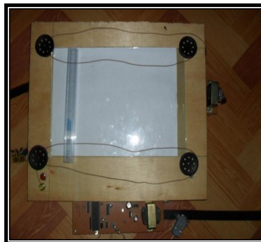
Gambar 4.12 Alat Penghapus Whiteboard Menggunakan Motor Stepper
