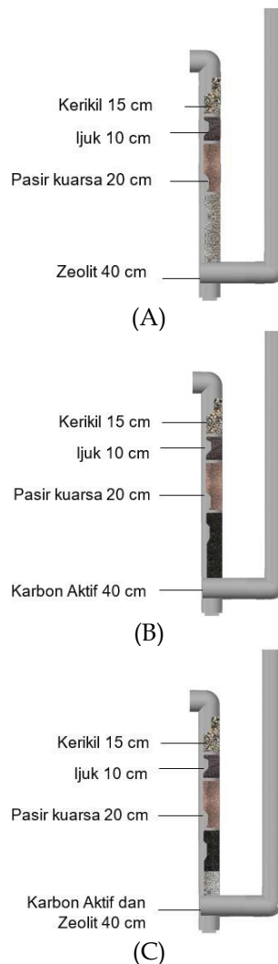
Gambar 2. Unit filtrasi (A) susunan 1, (B) susunan 2, dan (C) susunan 3
