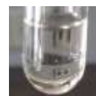
Gambar 4. Hasil Uji Kualitatif Ion Nitrat pada Senyawa Kompleks Hasil Sintesis
