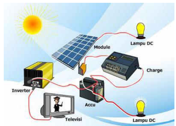
Gambar 8. Skema pemanfaatan energi surya untuk memenuhi kebutuhan energi dalam satu rumah
