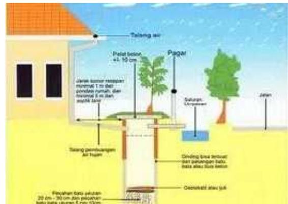
**Gambar 1. Sumur resapan dangkal**
