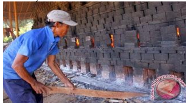
Gambar 9. Penyusunan dan pembakaran bata merah
