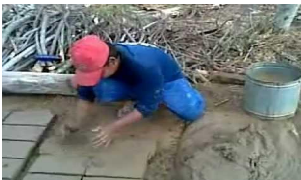
Gambar 7. Proses pencetakan bata merah
