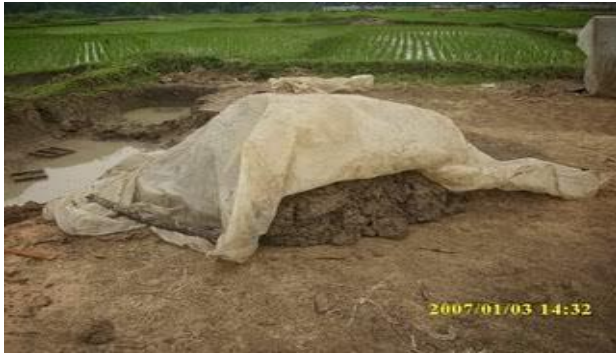
Gambar 5. Pemeraman tanah bahan bata merah
