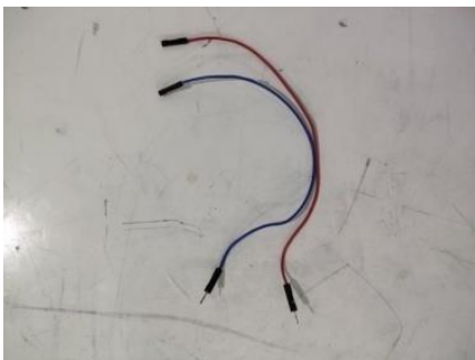
Gambar 8. Kabel jumper yang digunakan
