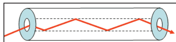
Gambar 3. Pemantulan Sempurna pada Serat Optik ( www.timbercon.com , 2009)
