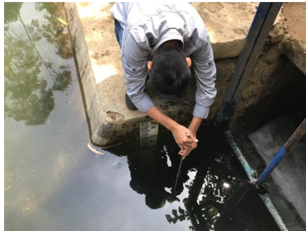
Gambar 3. Contoh pengambilan sampel sedimen layang dengan US DH-48 di Situ Cisanti
