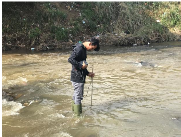
Gambar 2. Contoh pengukuran kecepatan aliran di Majalaya
