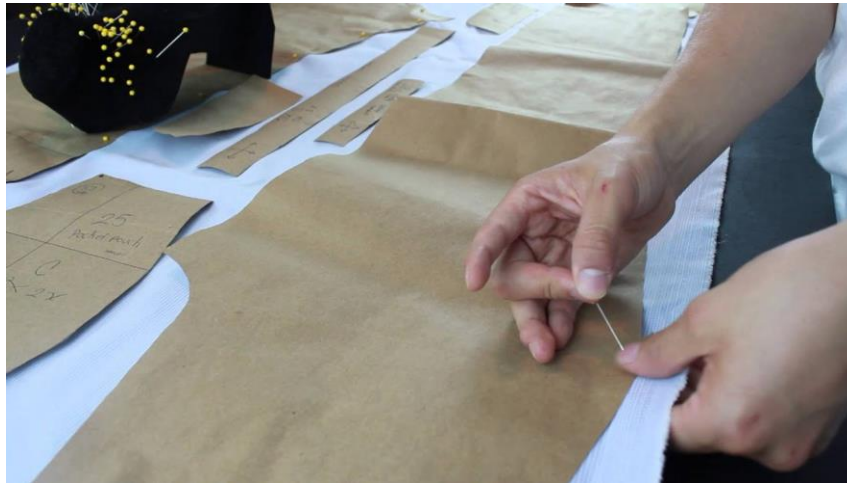
Gambar 5. Proses Pembuatan Pola Pantalon Manual.
