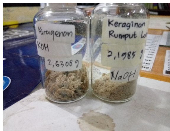
Gambar 1. Hasil ekstraksi rumput laut merah Eucheuma cottonii menjadi karaginan berdasarkan variasi pelarut alkali
